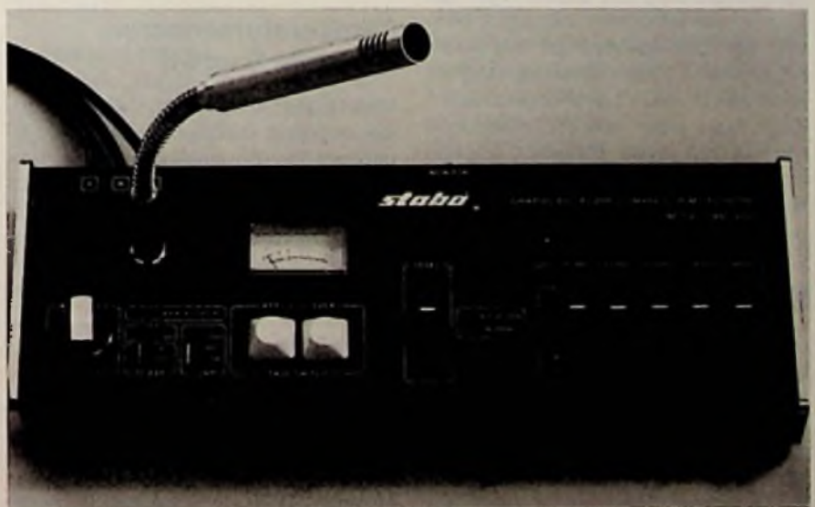
Bild 1. Besprechungsstelle für Amateurfunkstationen. Über den Drehschalter „OUTPUT“ kann immer eine von maximal 3 Amateurfunkstationen (A, B, C) mit dem Mikrofonsignal versorgt werden (Stabo)
