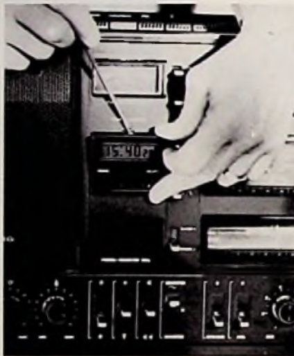
Bild 3. Die Quarzuhr hat eine eigene Stromversorgung. Sie kann deshalb auch extern vom Empfänger betrieben werden
