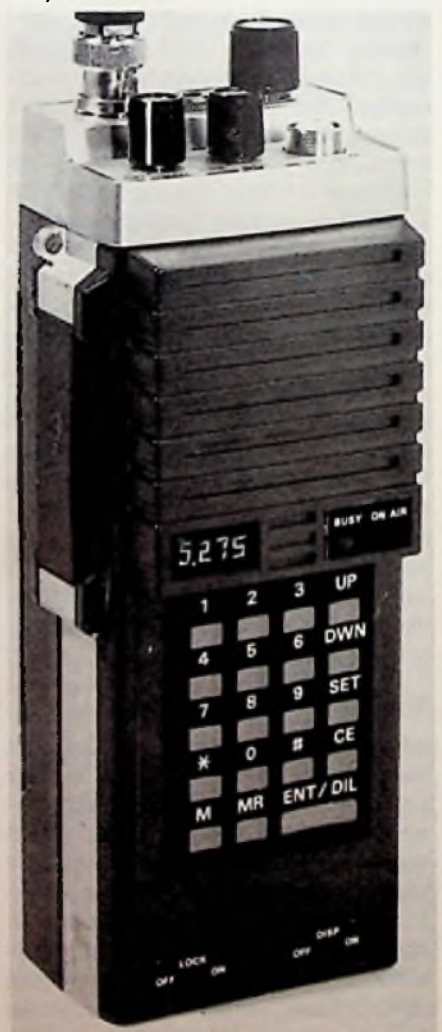
Bild 1. Computer-gesteuertes Handsprechfunkgerät „Yaesu FT-207R“ für das 2 m-Amateurband (Richter & Co.)
