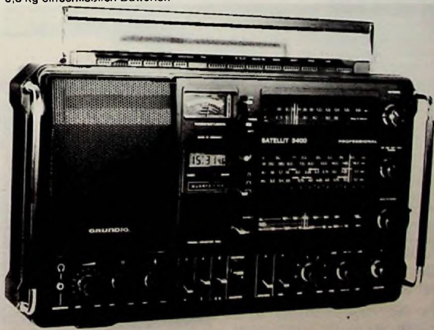
Bild 1. Der „Satellit 3400“ von Grundig hat 21 Empfangsbereiche (LW, MW, KW, UKW), von denen 18 auf die Kurzwellenbereiche 187 m bis 10 m entfallen. Das Gerät hat die Abmessungen 516 mm x 297 mm x 140 mm und wiegt 9,5 kg einschließlich Batterien
