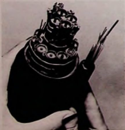
Bild 3. Größenvergleich zwischen einem Koax-Fernkabel und einem Lichtwellenleiter-(LWL-)Kabel mit gleicher Übertragungskapazität (AEG-Telefunken)
