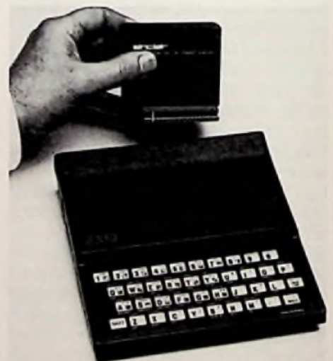
Bild 1. Alle Daten-, Adreß- und Steuerkontakte des Mikroprozessors Z-80-A sind an der Geräterückseite herausgeführt zum Anschluß eines 16-Kbyte RAM-Erweiterungsmoduls
