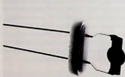
Bild 11: Eine montierte Quarzscheibe. Der Durchmesser der Schelbe beträgt 12 mm.
