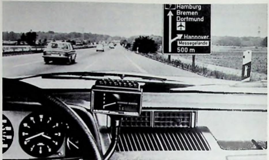
Bild 3: Bordgerät für das Autofahrerleit- und Informationssystem (Blaupunkt-Pressbild)
