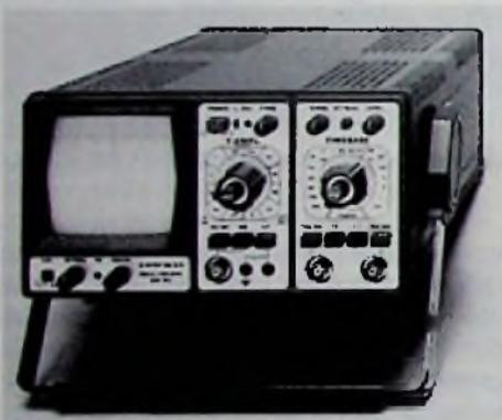
Bild 5: Preiswertes Einkanaloszilloskop, der HM 103 (Hameg-Pressebild)
