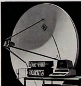
Bild 2: ► Steuerbare Richtantennenanlage AC 002 mit Parabol, Erreger, Motorsteuerung und Bediengerät, das über den process Controller (rechts) angesteuert wird. (Rohde & Schwarz-Pressbild)
