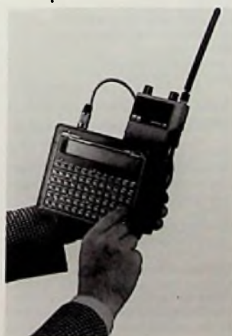
Bild 1: Terminal 1200 mit alphanumerischem Keyboard und LCD-Display hier an ein Handfunksprechgerät (Autophon SE 20) angeschlossen (data geet-Pressbild)
