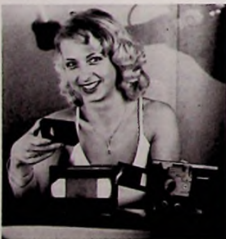
Bild 9: Adapter für die neue VHS-Minicasette (Blaupunkt-Pressbild)
