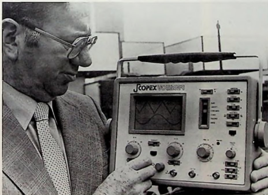
Bild 1: Nur 100 mm tief ist dieses Zweistrahlspeicheroszilloskop mit zweifarbiger Anzeige
