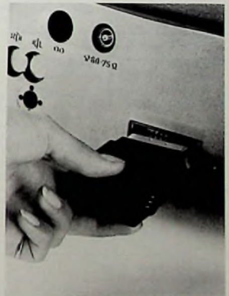
Bild 4: Alte und neue Stecksysteme können über Adapter miteinander kombiniert werden Bild: SABA-Pressbild
