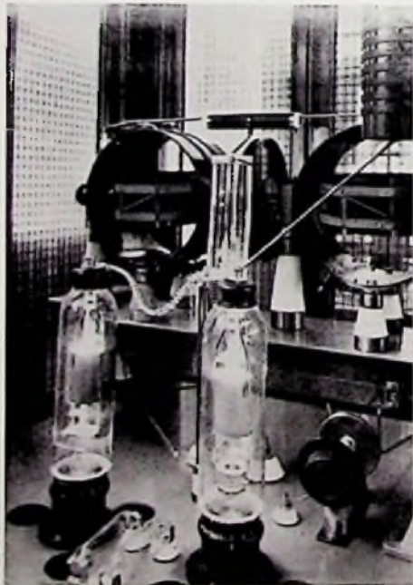
Bild 2 500 W Ausgangsleistung lieferte die vierte Verstärkerstufe mit zwei parallelgeschalteten RS 214.
