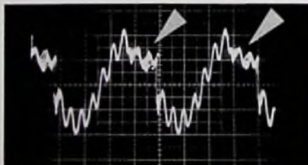
Bild 7: Beim Modell MC-1 sind 10 mN Auflagekraft besonders dann kritisch, wenn die Schallplatte einen Höhengschlag aufweist (Verzerrungseinsatz: s. Pfeil)
