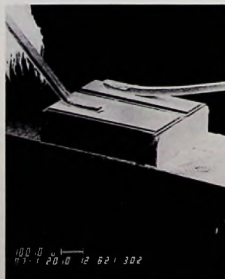
Bild 2: Gallium/Aluminiumarsenid-Laserdiode mit integrierten Monitordioden (Siemens-Pressbild)
