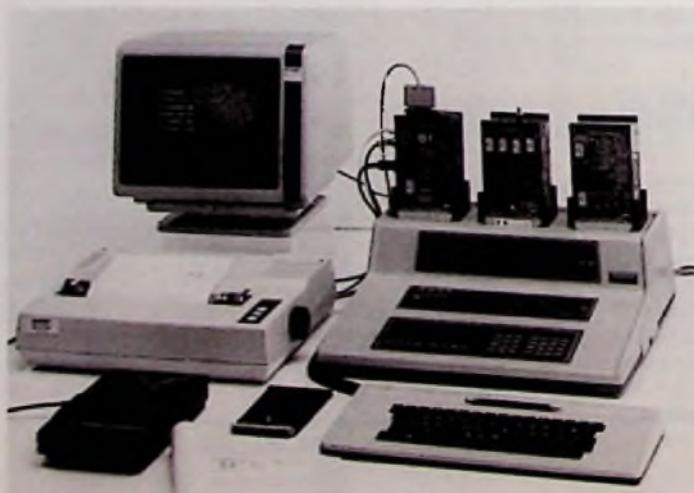
**Bild 1:** Mikrocomputer-Trainingsgerät mit aufgesetzten Applikations-Platinen (P + G-Pressebild)
