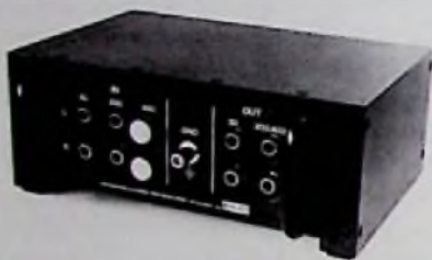
Bild 2: Ein sehr aufwendiger Anpaßtrafo mit wählbaren Ein- und Ausgangsimpedanzen. Er kann den in Bild 1 gezeigten aktiven Verstärker ersetzen (Audio-Technica-Pressbild)
