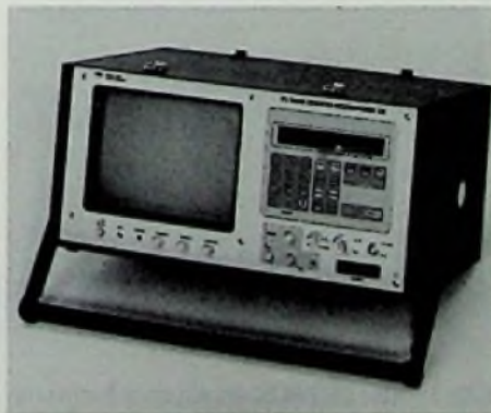
Bild 11: Ein computergesteuerter Antennenmeßempfänger mit vielfältigen Meßmöglichkeiten (Heynen-Pressbild)
