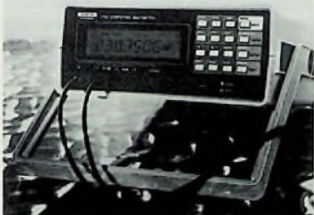
Bild 4: Das Digital-Multimeter DM7151 ist ein regelrechter Meß-Computer, dessen Analogausgang jedes angeschlossene Oszilloskop in ein grafisches Display mit Lupe-Funktion verwandelt
