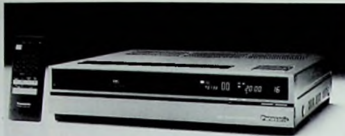
Bild 1: 99 mm hoch ist der mit Doppelköpfen ausgerüstete Video-Recorder (Panasonic-Pressebild)
