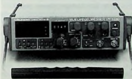
Bild 10: Zeilenweise auf den Punkt genau kann mit dem Video-Pegelmesser VP 1030 gemessen werden. Eine Einblendmarke am Monitorbild zeigt den gemessenen Bildpunkt (Grundig-Pressbild)
