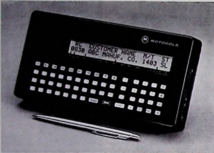
Bild 1: Drahtloses Computer-Terminal (Motorola-Pressbild)
