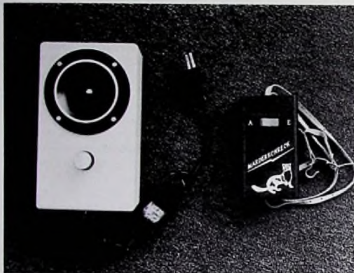
Bild 1: Elektronischer Marderschreck für Kraftfahrzeuge (Elomex-Pressbild)
