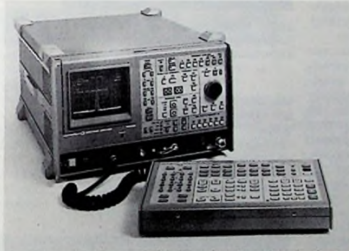
Bild 1: Mikrowellen-Spektrumanalysator bis 20 GHz (RSE-Pressbild)
