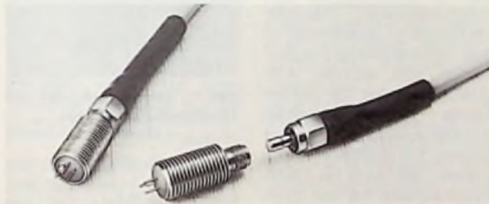
Bild 1: Optisches Digitalübertragungssystem für 10 Mbit/s (Hirschmann-Pressbild)
