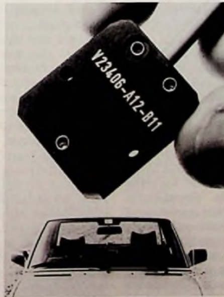
Bild 1: Magnetsonde registriert den Winkel zum Erdmagnetfeld (Siemens-Pressbild)
