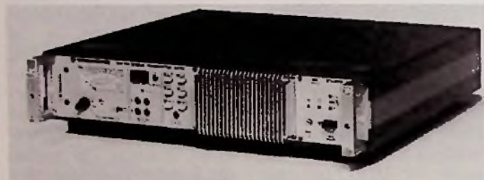
Bild 1: Kompakter VHF-FM Sender mit maximal 10 W-Ausgangsleistung (Rohde & Schwarz-Pressbild)
