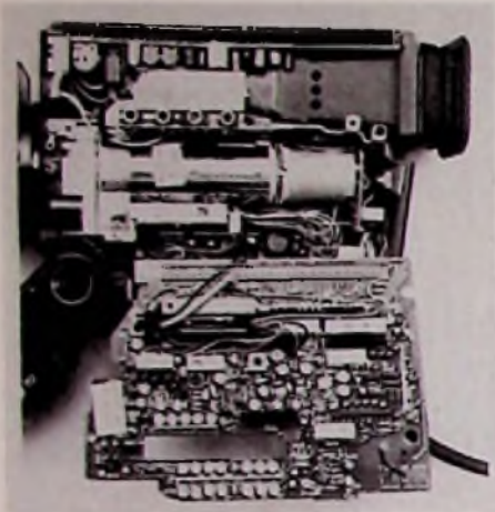
Bild 7: Geringe Kamera-Abmessungen haben zwangsläufig eine erhöhte Packungsdichte und einen erschwerten Service zur Folge
