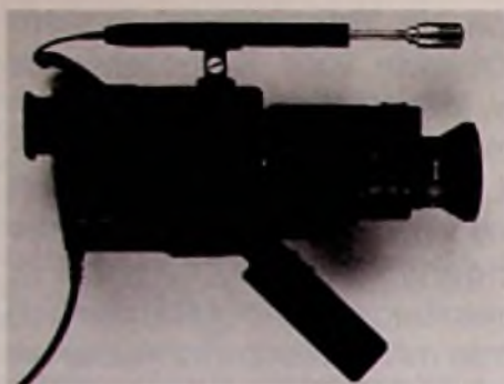
Bild 2: Das kompakte Auto Focus-System im neuen Modell VK-4053 ist als Baugruppe mit dem Wechselobjektiv verbunden (Philips-Pressebild)
