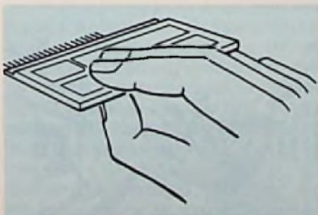
Bild 1: So können LCD-Displays beschädigt werden
