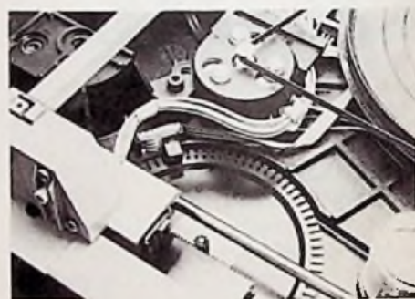
Bild 6: Lager und Antrieb des Tonarmschlittens beim CST 100
