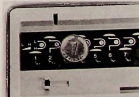
Bild 2: Die Einstellelemente der mechanisch abstimmbaren Programmspeicher sind ungewöhnlich klein
