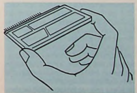
Bild 2: Richtige Behandlung von LCD-Displays
