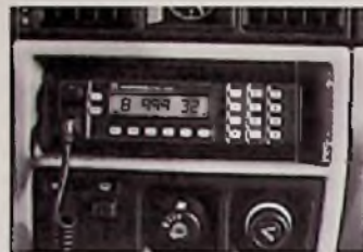
Bild 1: Mobilfunk-Station für nichtöffentlichen Landfunkdienst nÖL (Motorola-Pressbild)
