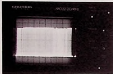
Bild 8a: Darstellung des VPS-Codes auf dem Oszilloskop
