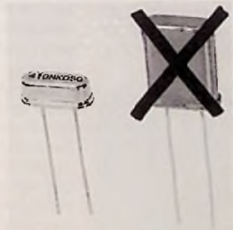
Bild 1: Größenvergleich zwischen den neuen und alten Quarzgehäusen (Data-Quarz-Presebild)
