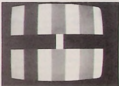
Bild 7: Das „bewegte Testbild“ eingeblendet in die Farbbalken
