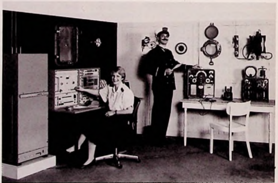
Bild 1: Seefunkstationen heute (links) und damals. Ganz rechts ein Löschfunktensender aus dem Jahre 1911 (DEBEG-Pressbild)
