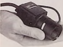
Bild 1: Kleine Überwachungskamera mit Halbleiter-Bildsensor (Panasonic-Pressebild)
