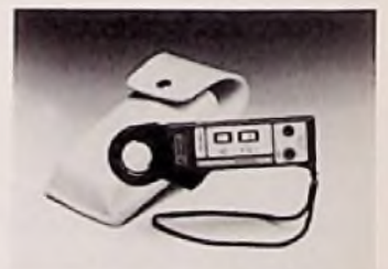
Bild 1: Moderne Meßzange mit Digitalanzeige (Beckmann-Pressbild)
