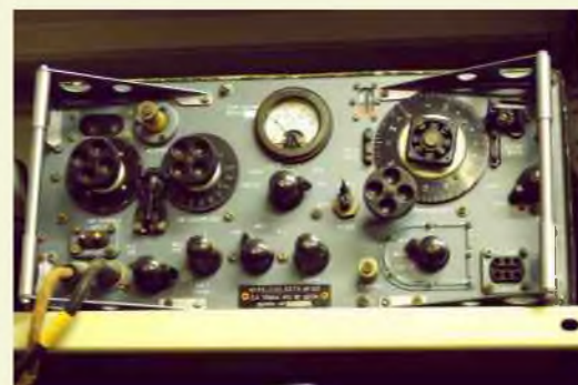
WS-62: émetteur-récepteur anglais, conçu et fabriqué par la maison PYE, en 1943/4. Couvre de 1.6 à 10MHz en AM et CW, avec une puissance d'environ 1W.
