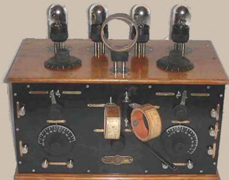
Récepteur C119 étage HF accordé et réglage de réaction par couplage variable (modèle N°1)
