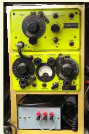
WS-21: émetteur-récepteur anglais couvrant de 4.2 à 7.5 Mhz et de 19 à 31 Mhz.
