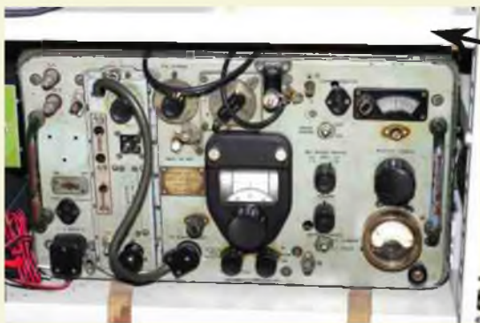
WS-48: émetteur-récepteur portable de 1942. Fabriqué aux Etats-Unis et utilisé durant la 2ème guerre par les anglais et les alliés en général. Couvre de 6 à 9 Mhz en AM et CW. Puissance de 250mW. Très joli objet de collection.
