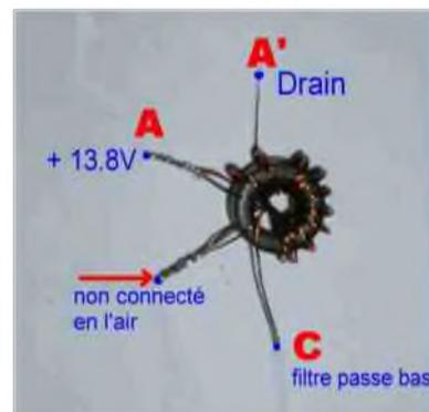
Photographies du détail de la confection du transformateur trifilaire. La partie marquée en l'air est repliée légèrement sans aucune incidence sur le fonctionnement et la puissance de sortie.
