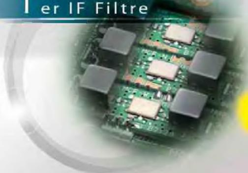
Equipé de 3 « roofing filters » : 3 kHz, 6 kHz et 15 kHz !
