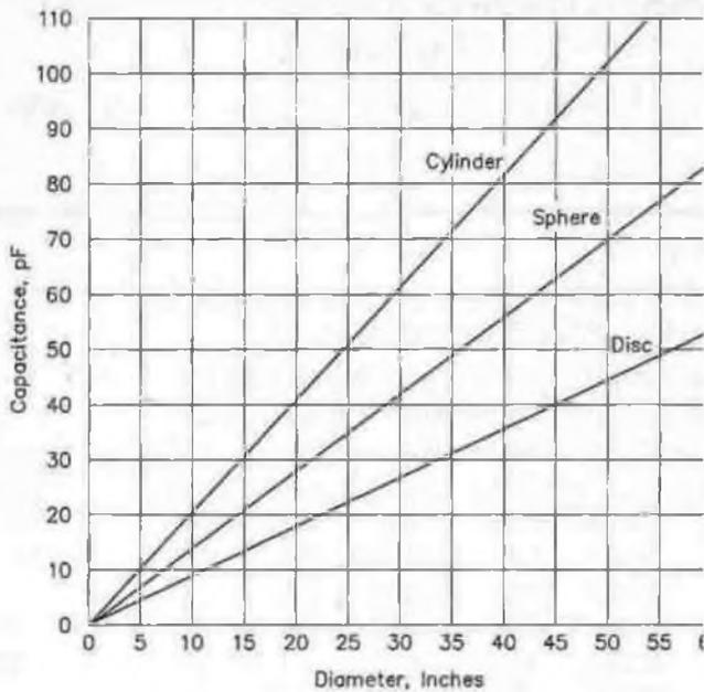
L'efficacité de la charge capacitive dépend de sa constitution et de sa géométrie. Un simple fil horizontal représente environ 6pf/m.
