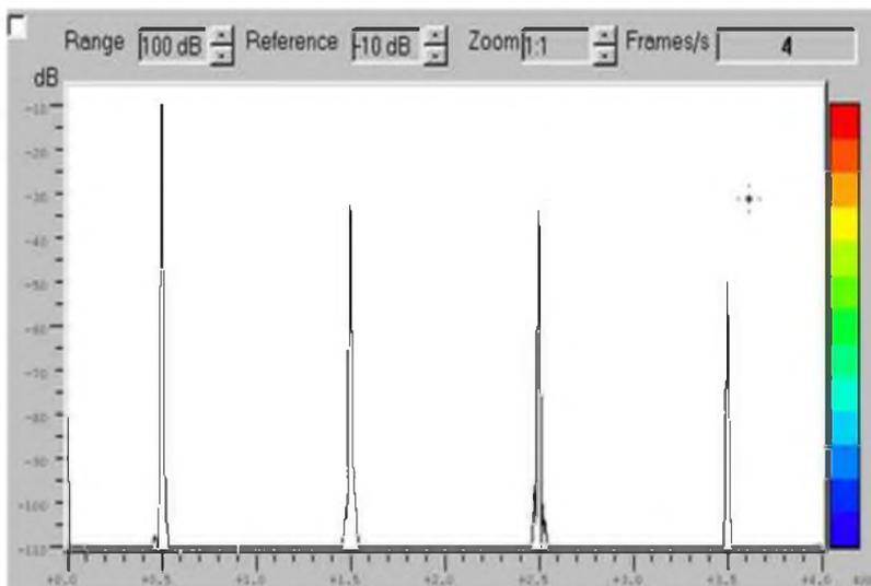
Voici à titre d'exemple, des signaux de fréquence 2000Hz pour  $f_1$  et 50 Hz pour  $f_2$ .
