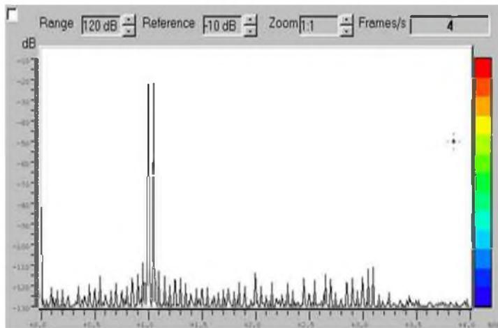
Addition de 2 ondes sinusoïdales 1000 Hz et 1050 Hz
