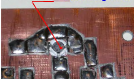
Photo 10 BFR96 dans le logement
