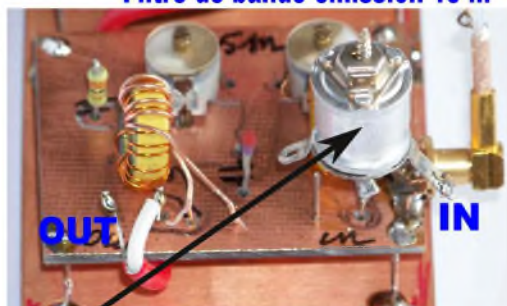
CV cloche entrée Haute Impédance = HI--Z
