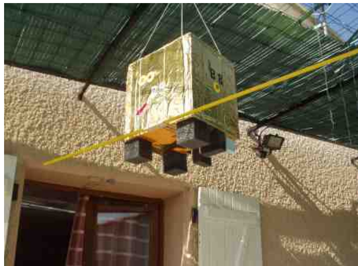
Nacelle inférieure, avec le dipôle 144 MHz de la balise émettrice
