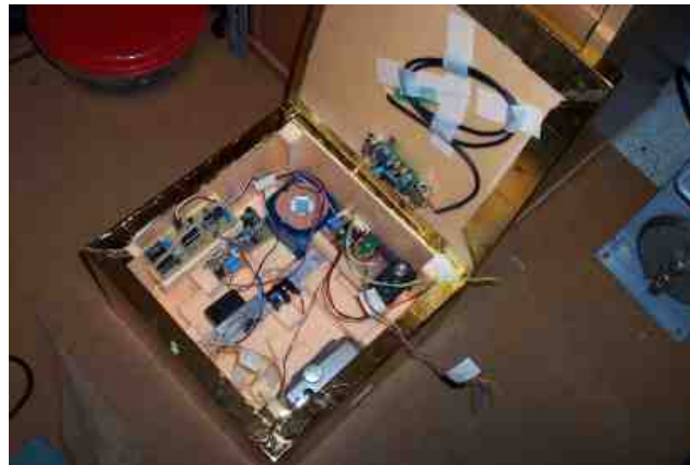
L'intérieur de la nacelle supérieure, toute l'électronique n'est pas installée, au fond le système de largage de la petite sœur.
