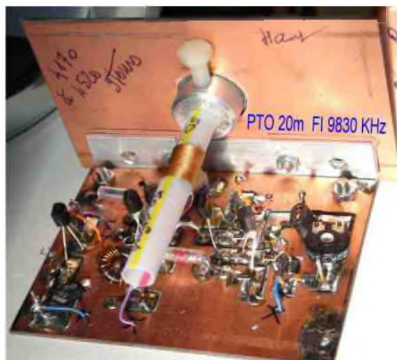
De la cornière Alu pour solidariser façade et circuit PTO
