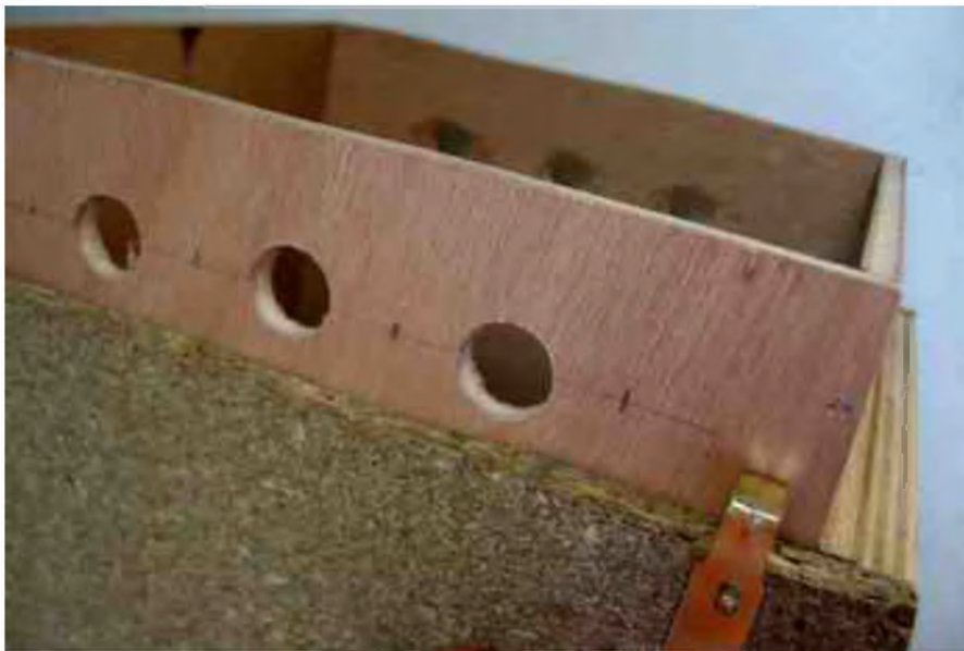
Figure 3 : Détail des lumières pour le Tektronix 2225 et des crochets pour le HP 182T.
