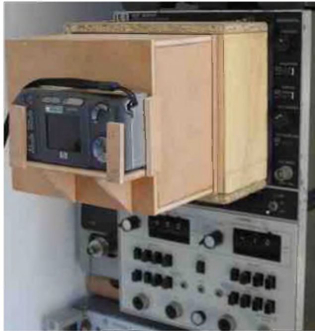
Figure 3 : Adaptation à l'oscilloscope Tektronix 2225
