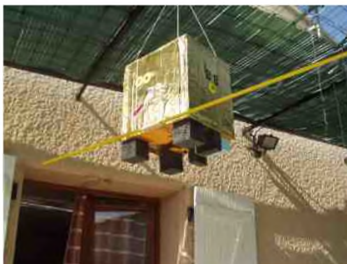
Nacelle inférieure, avec le dipôle 144 MHz de la balise émettrice
