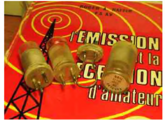
De gauche à droite : Inductance ouverte et partiellement débobinée, inductance n°3, inductance n°1 et inductance n°9
