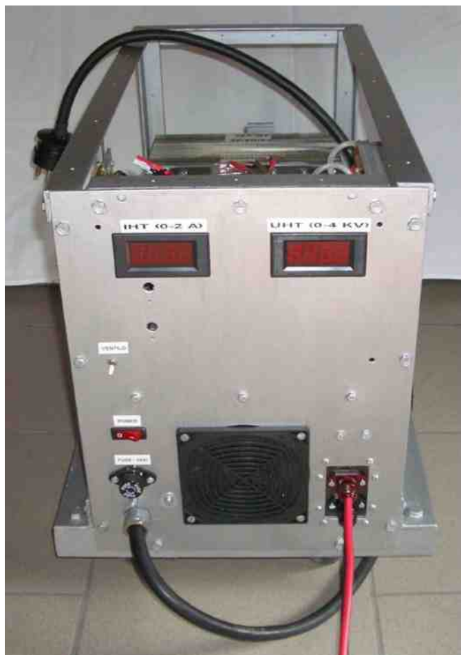
Photo n° 2 : l'alimentation HT (4KV-2A).
