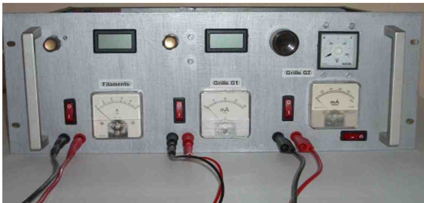
Photo n° 3 : l'alimentation du filament et des grilles G1 et G2.
