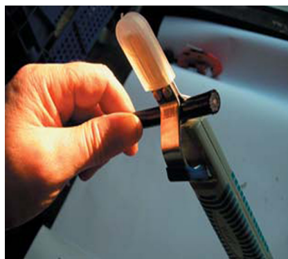
photo 2 : dénuder au moyen d'un couteau à dénuder
