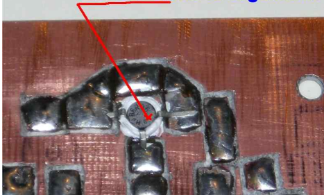
Photo 10 BFR96 dans le logement
