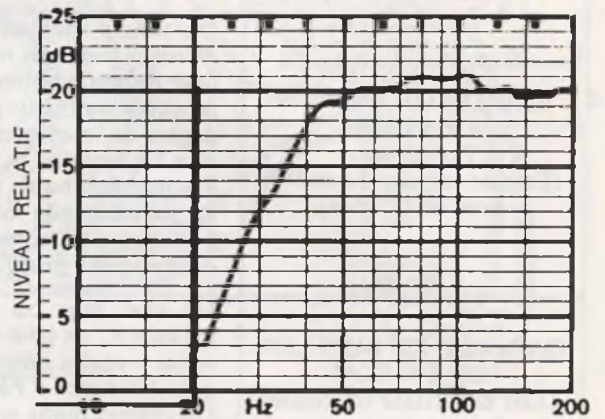
CARACTÉRISTIQUE DE LA COUPURE GRAVE DU KIT MTX 50 (mesuré en chambre anéchoïque)
