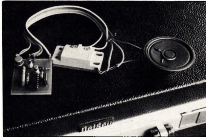
Douze composants à souder, une alimentation par pile de 4,5 V et ça fonctionne.
