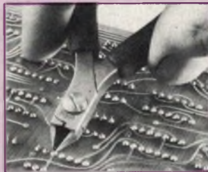
Une pince coupante permettant d'effectuer les travaux délicats.
