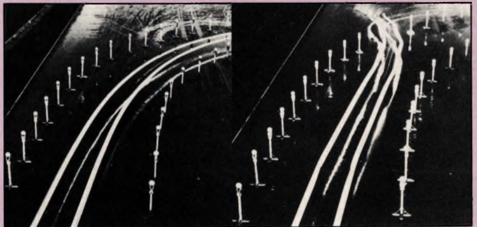
Efficacité de l'ABS sur une route glissante au freinage avant une courbe. A droite, la voiture avec freinage ABS : elle suit parfaitement la trajectoire. A gauche, sans ABS, la voiture zigzague et sort de la route.
