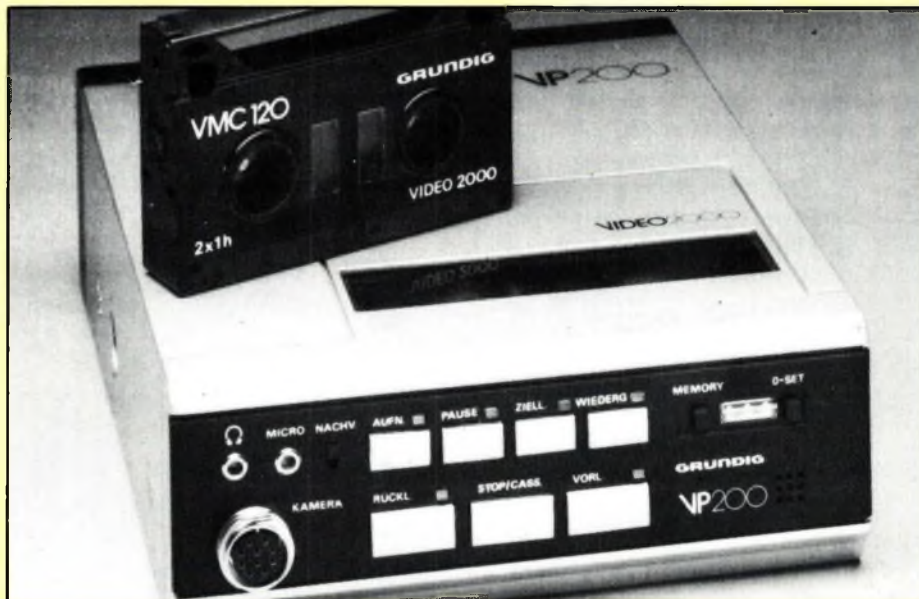
Le magnéscope VP 2000, au standard V 2000, s'utilise avec des cassettes miniaturisées VMC 120, réversibles, de 2 × 1 H. La VMC 120 est, en fait, constituée de deux parties symétriques verrouillées en utilisation portable, mais se séparant dès qu'elle est chargée dans l'adaptateur.
