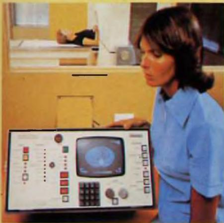
Console de contrôle d'un tomodensitromètre.
