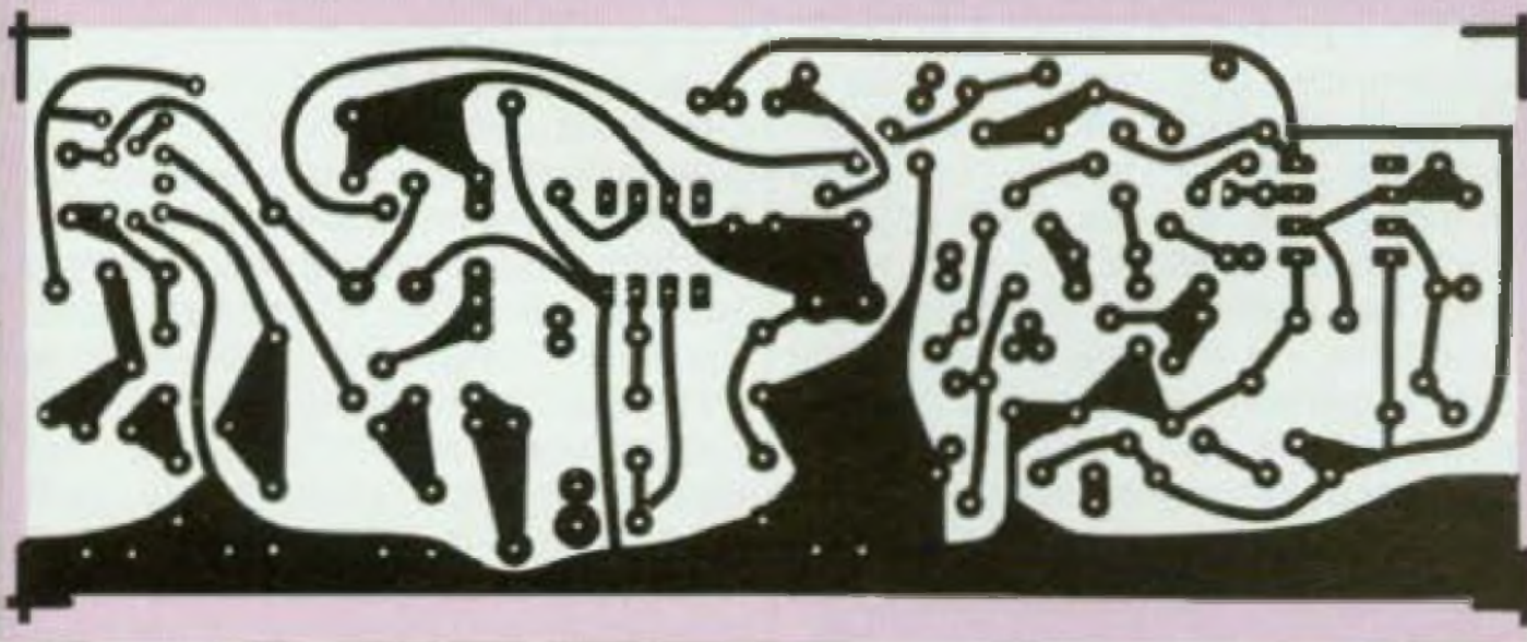
Emetteur AM.272 - partie haute fréquence
