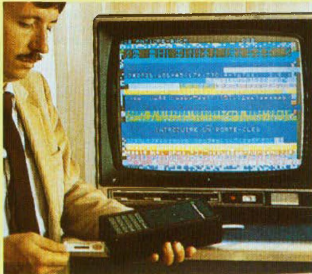
Boîtier de décodeur permettant l'utilisation d'une carte électronique d'accès aux magazines réservés.
