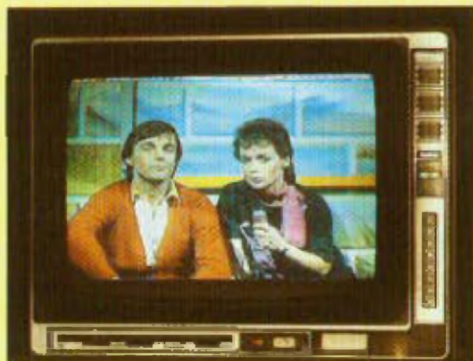
Volontairement décalée, l'image TV permet de visualiser les données numériques qui se présentent sous la forme d'une barre lumineuse, en haut de l'écran.
