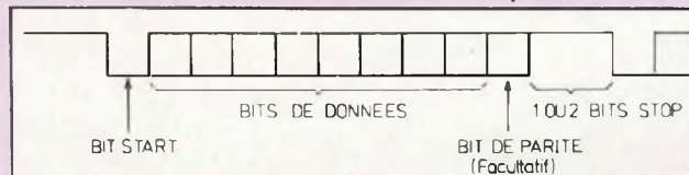
Fig. 1 : Format de transfert d'une liaison série asynchrone.
