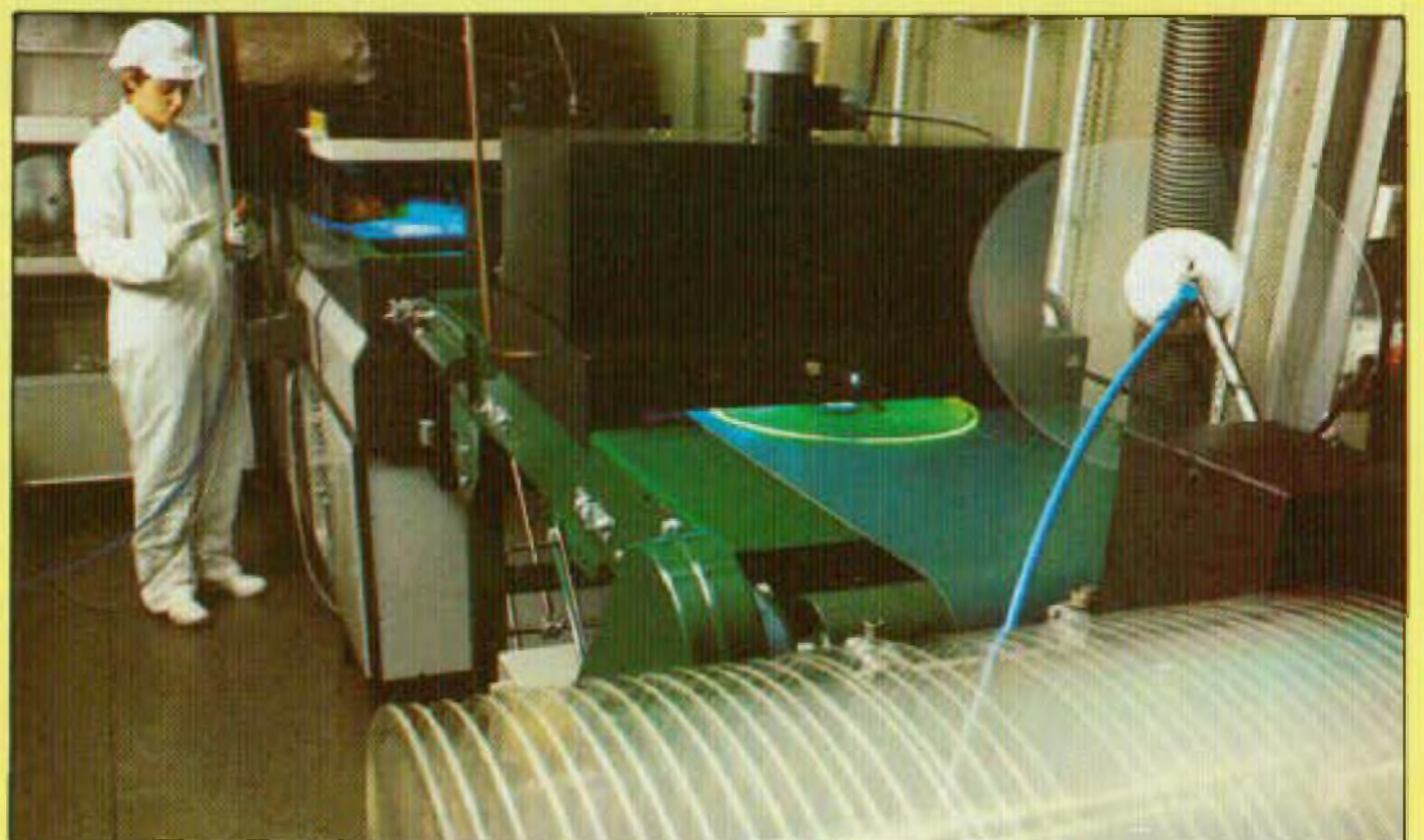
En cours de fabrication, les vidéo-disques LaserVision sont soumis à une exposition aux rayons ultra-violet.
