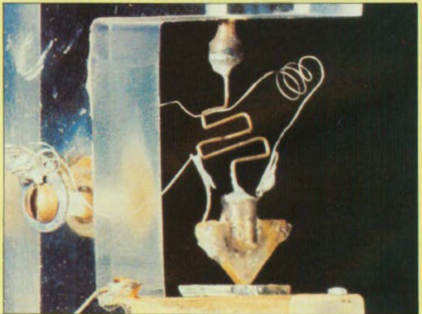
Le premier transistor à pointe (1947), inventé par Bardeen, Brattain et Shockley.
