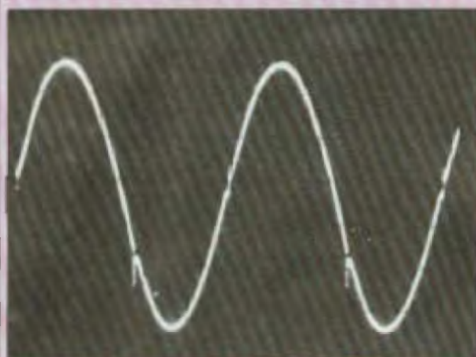
Signal sinusoïdal à 10 kHz. Amplitude 3 V c. à c.
