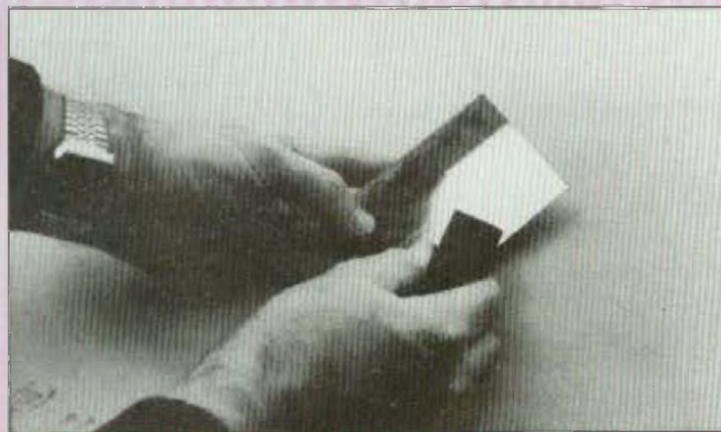
Nettoyer soigneusement le circuit imprimé à l'aide de la gomme spéciale.
