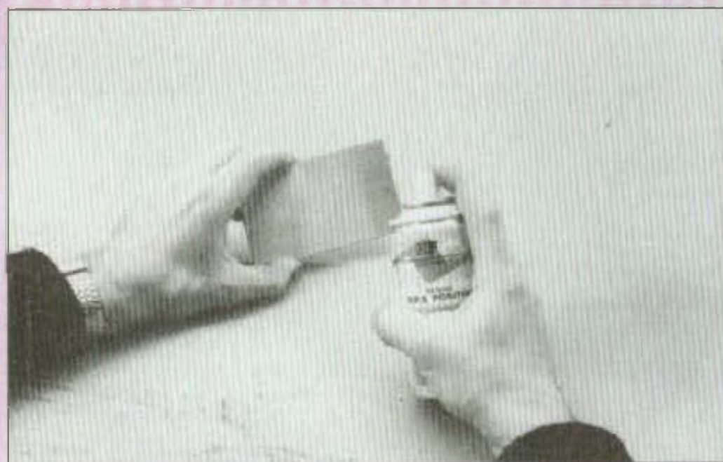
Présensibilisation de la surface du circuit imprimé.
