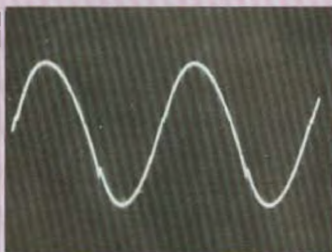
Signal sinusoïdal à 1 kHz. Amplitude 2.4 V c. à c.
