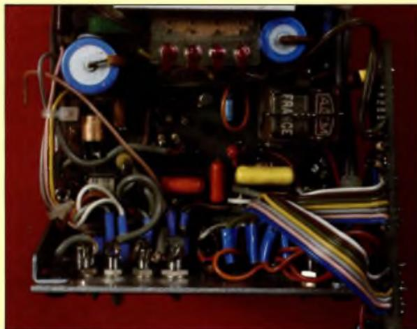
Le circuit imprimé principal se fixe au fond du coffret.
