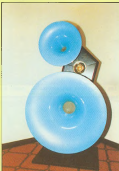
Enceinte ATR à pavillon et tweeter ionique.
