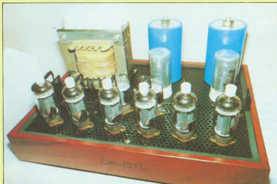
Amplificateur OTL à tubes de 150 W du D' Klimo.
