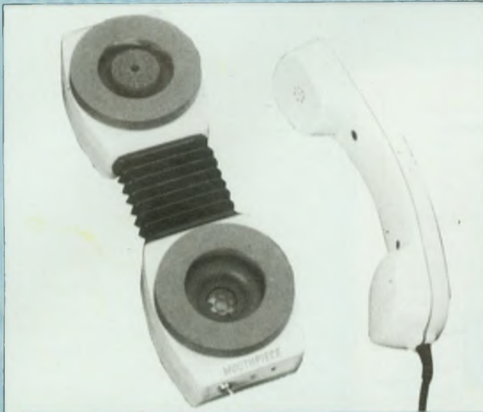
Fig. 7 : Interface acoustique pour Modem (Doc CDT)
