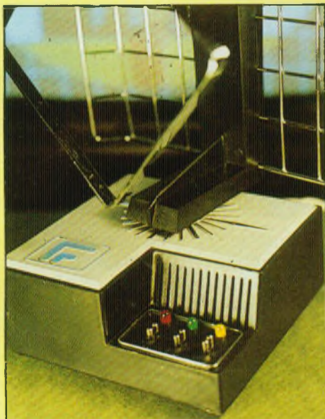
Détail du socle-support et du «pupitre» de commande. L'alimentation secteur et l'amplificateur U.H.F. sont abrités dans le socle
