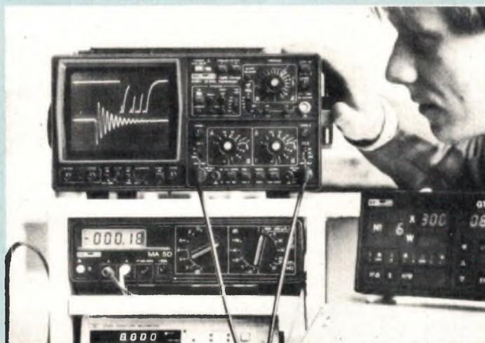
Le point de déclenchement dans l'intervalle de la longueur de mémoire est réglable par pas de 25 %, si bien que le pré-déclenchement est réglable sur 0,25, 50, 75 et 100 %. La visualisation normale se fait en mode rafraîchi. L'appareil peut être utilisé en mode «défilement déclenché» avec des signaux et des bases de temps lents, et en mode défilement avec des signaux très lents.
