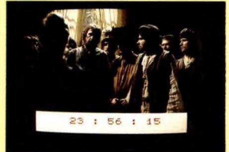
Fig. 3 : Variante de la pendule numérique incrustée dans l'image TV obtenue par l'instruction CONSOLE (ligne 90 du programme C).
