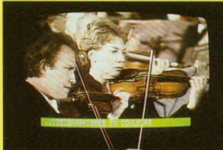
Autre exemple de titrage à défilement horizontal. La hauteur du bandeau de couleur est automatiquement adaptée à la hauteur des lettres.
