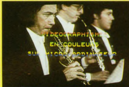
Dans le cas d'un titrage multicolore réalisé à partir de programmes tels que (B) ou (C), les lettres prennent une double coloration aux changements de zones.
