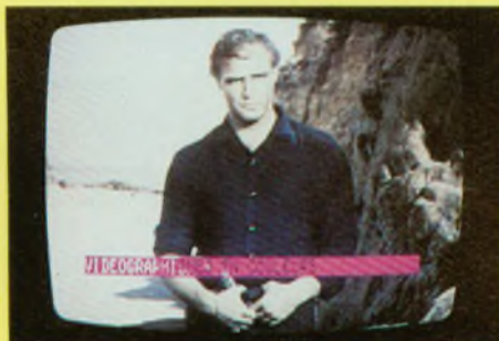
Quand on choisit le noir («0») pour la couleur des lettres, celles-ci apparaissent en transparence dans le bandeau de couleur et laissent voir l'image vidéo dans leur découpe.
