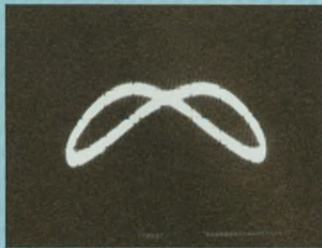
Distorsion d'un générateur basse fréquence présentant de l'harmonique 2. Distorsion 0,5 %.
