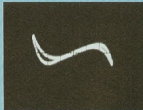
Distorsion due à la présence d'harmonique 3. Distorsion 0,15 %.
