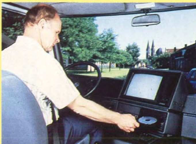
C) Le système CARIN est activé en mettant en place un «Compact-Disc» ayant en mémoire la cartographie de la zone traversée.
