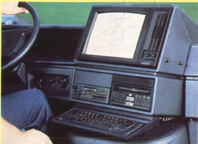
B) Les éléments constitutifs du système CARIN comprennent un lecteur de «Compact-Disc», un ordinateur de bord, un clavier de commande, une console de visualisation et un auto-radio.
