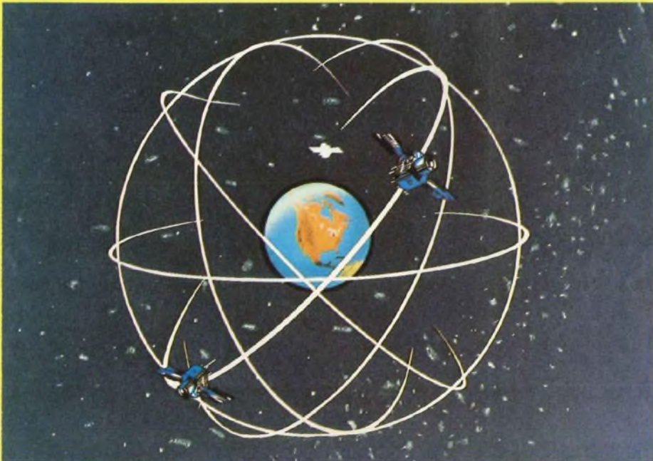
Fig. 3 : Actuellement, le système de navigation GPS (Global Positioning System) NAVSTAR se compose de 6 satellites ceinturant l'espace terrestre.
