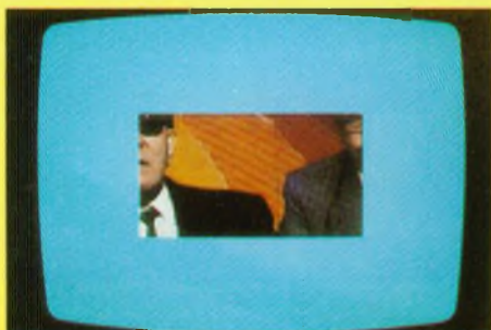
Fig. 12 : Effet « de fenêtre » correspondant à l'apparition progressive, à partir du centre, d'un rectangle-image, de dimensions croissantes.
