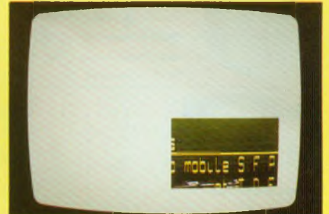
Fig. 16 : Effet « de diagonale » correspondant à l'apparition progressive d'un rectangle-image, de dimensions croissantes, se développant à partir du coin inférieur droit de l'écran-graphique.
