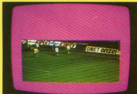
Fig. 9 : Effet -guillotine- Inversé, correspondant à l'apparition progressive d'une image TV, à partir du bas de l'écran.
