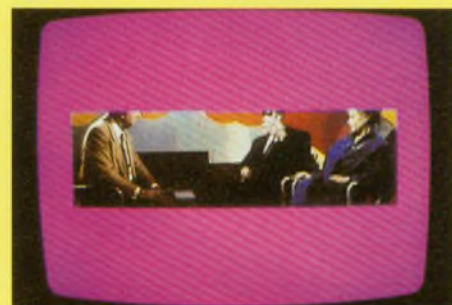
Fig. 11 : Effet -de ruban- correspondant à l'apparition progressive d'un bandeau-image – de hauteur croissante –, à partir du centre de l'écran.
