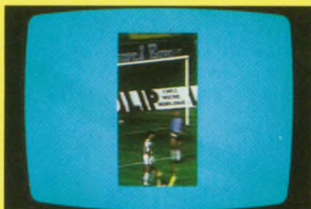
Fig. 6 : Effet -de rideau- correspondant à l'apparition progressive, à partir du centre de l'écran, d'une image TV.
