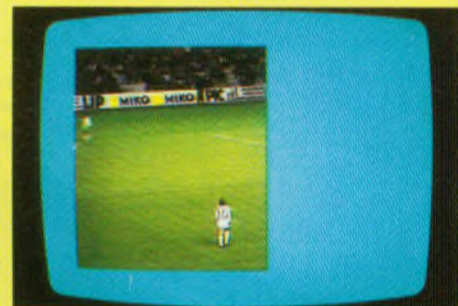
Fig. 4 : Effet « de rideau » correspondant à l'apparition progressive, de la gauche vers la droite, d'une image TV.
