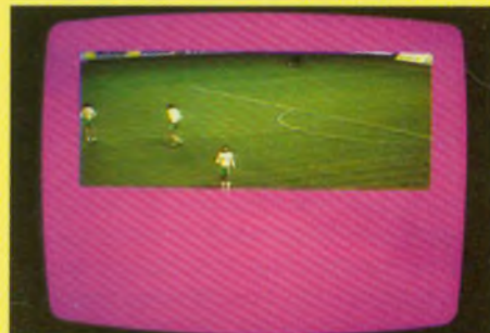
Fig. 8 : Effet -guillotine- correspondant à l'apparition progressive d'une image TV, à partir du haut de l'écran.
