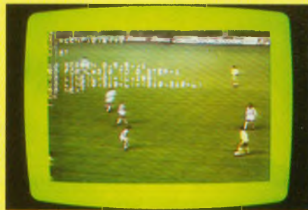
Fig. 3 : « Listing » apparaissant en blanc, en surimpression sur une image TV, bordée d'un cadre vert et obtenu à partir de l'instruction SCREEN 7,0,2,, 1.
