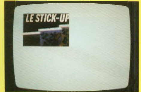
Fig. 15 : Effet « de diagonale » correspondant à l'apparition progressive d'un rectangle-image, de dimensions croissantes, se développant à partir du coin supérieur gauche de l'écran-graphique.
