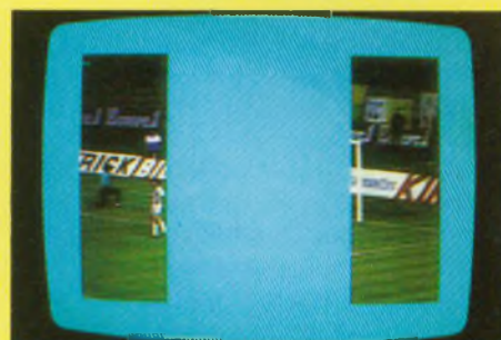
Fig. 7 : Effet de -double rideau- correspondant à l'apparition progressive, à partir des bords gauche et droit de l'écran, d'une image TV.
