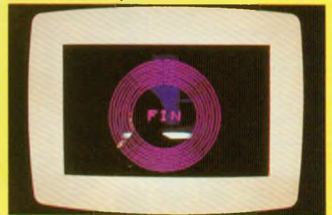
Fig. 19 : Effet « de fenêtre » obtenu à partir du programme B correspondant à la disparition progressive de l'image TV et du texte en surimpression.
