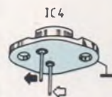
IC4 est à fixer sur un dissipateur.
