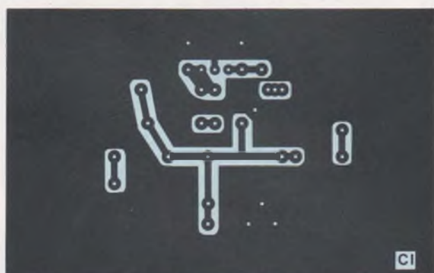
Fig. 2 : Implantation du circuit imprimé avec plan de masse.
