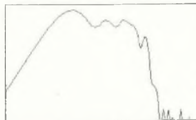
Fig. 4B : Zoom amplitude-fréquence en fonction du temps (délais) Obtenu par découpage de la courbe en trois dimensions (fig. 4A).
