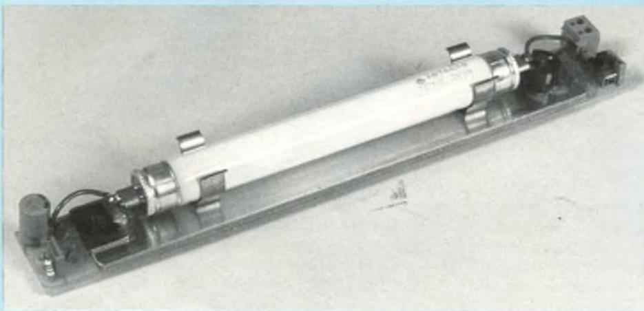
Cette réalisation s'adresse plus particulièrement aux possesseurs de caravane et camping car et aux adeptes du camping. Mais elle peut être utilisée sur tout navire de plaisance et sur n'importe quel véhicule automobile si la tension de la batterie est de 12 volts.
