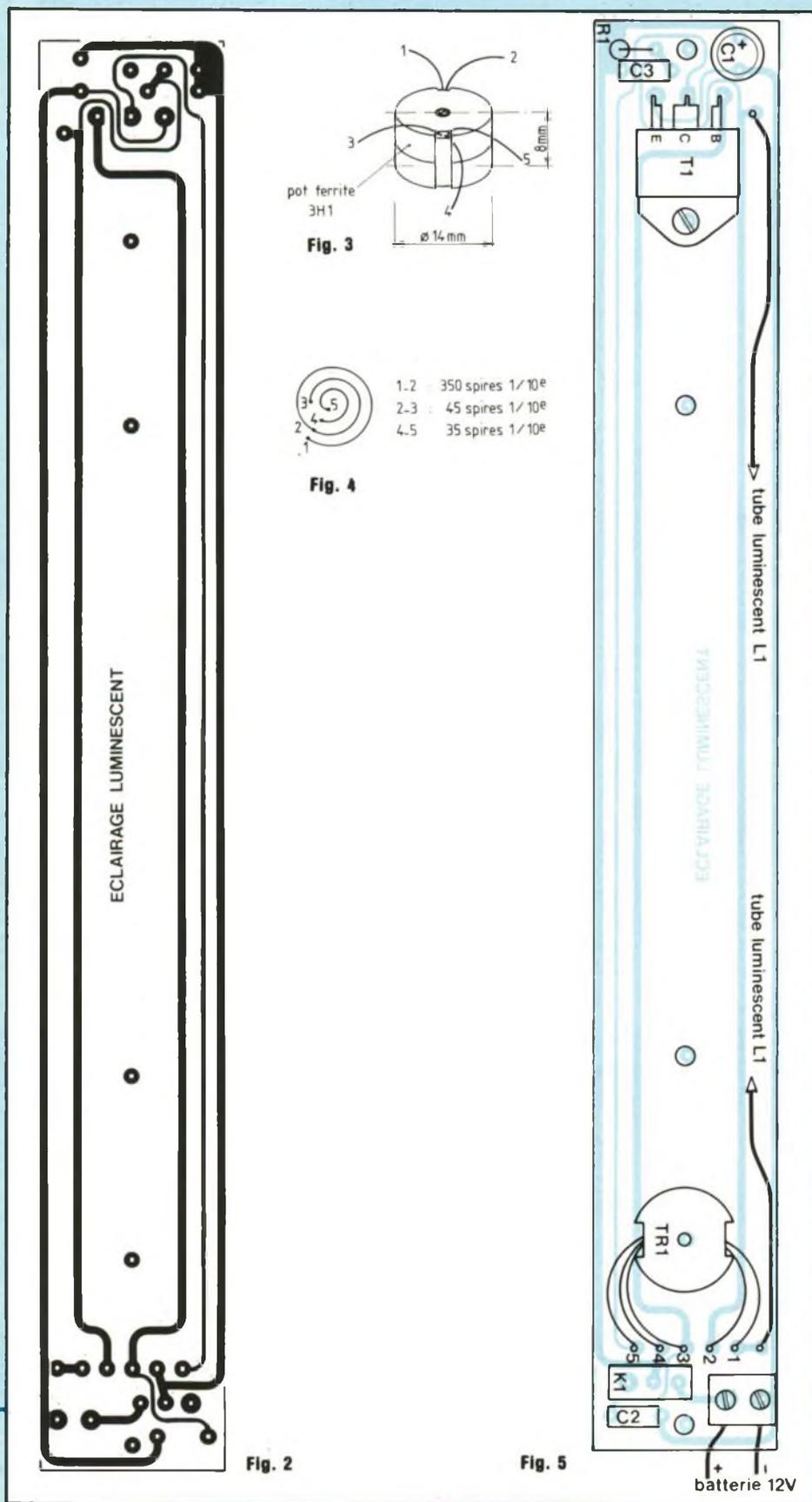
allié à une esthétique irréprochable. Le circuit imprimé est donc dessiné pour supporter tous les composants électroniques ainsi naturellement que tube luminescent, réflecteur de lumière et interrupteur arrêt/marche.
