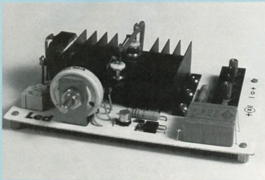
Dans la première partie, le côté théorique de notre réalisation a été abordé et nous avons indiqué que notre variateur de vitesse à couple constant permettait de descendre à quelques tours/minute en pouvant d'un autre côté monter à une vitesse de rotation au-delà de la vitesse nominale de la machine tout en conservant le couple rigoureusement constant. Voyons maintenant le côté pratique de cette étude, en commençant par le câblage du circuit imprimé.
