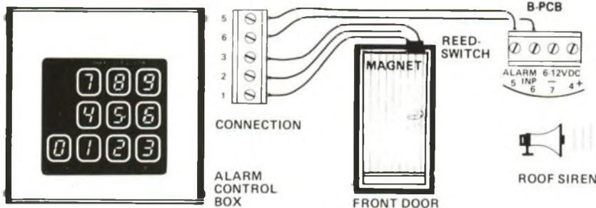
Raccordement d'un relais REED fixé sur une porte.
