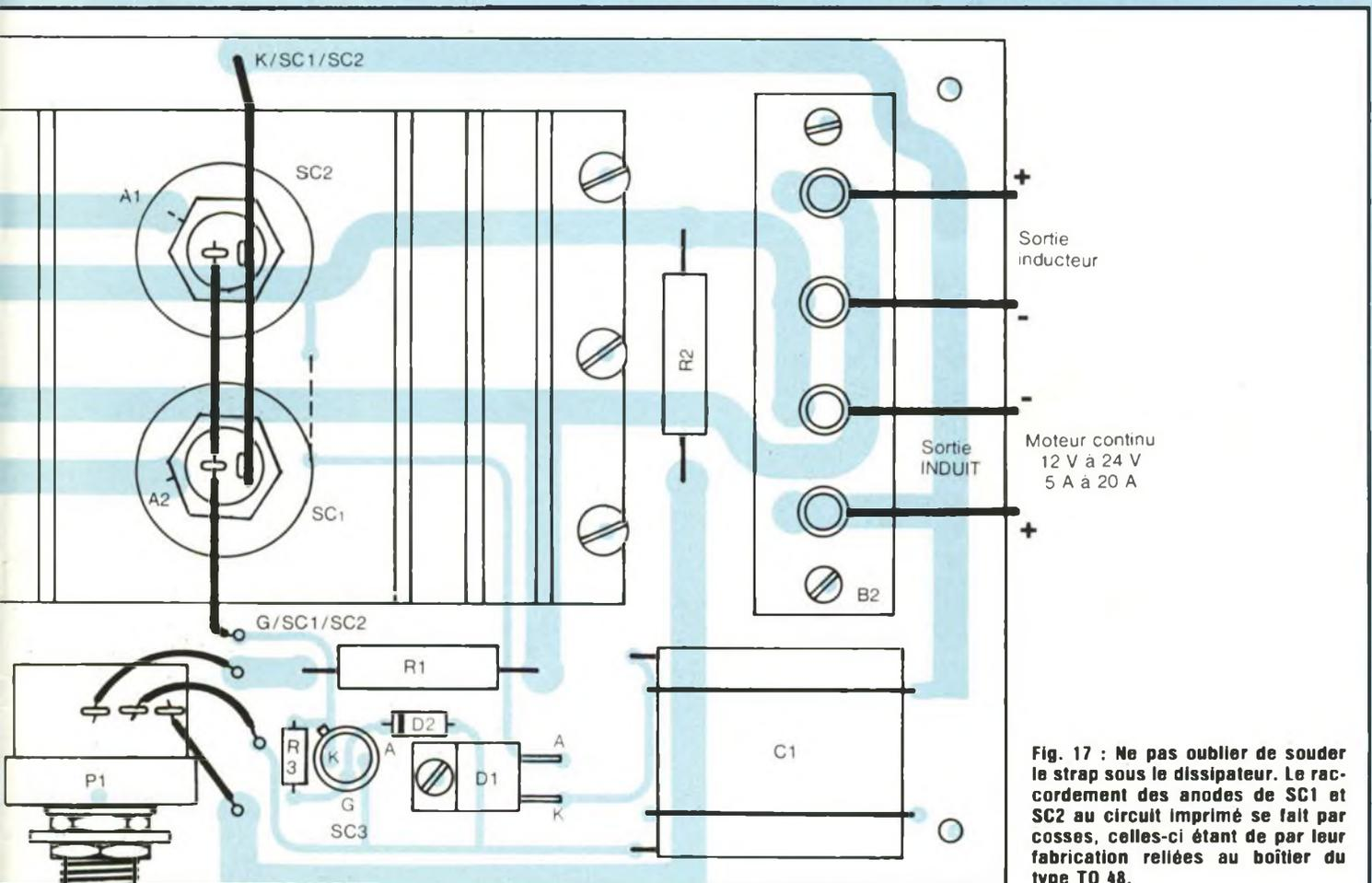
Fig. 17 : Ne pas oublier de souder le strap sous le dissipateur. Le raccordement des anodes de SC1 et SC2 au circuit imprimé se fait par cosse, celles-ci étant de par leur fabrication reliées au boîtier du type TO 48.
