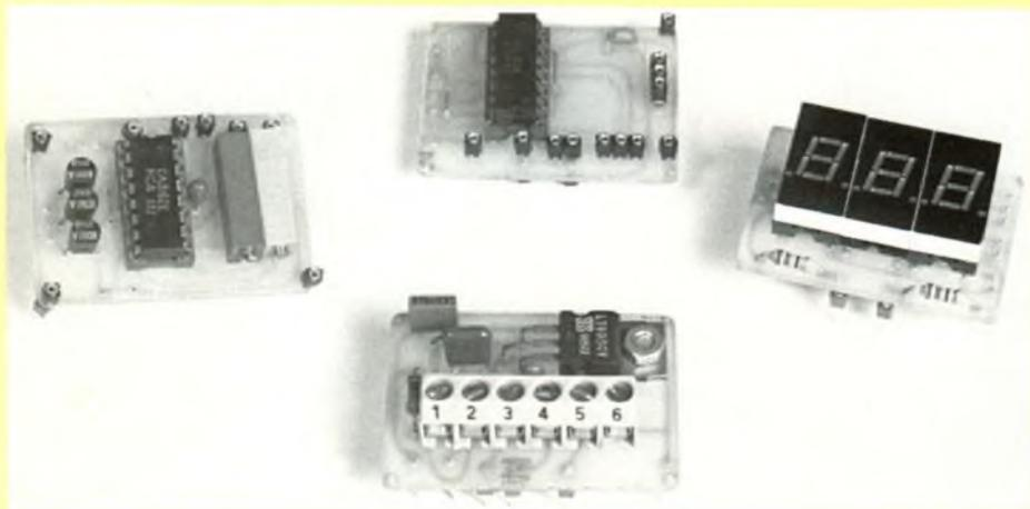
Ce module d'affichage est un voltmètre que nous avons qualifié d'"universel". En effet, si l'on s'en réfère à ses caractéristiques, il mérite bien ce qualificatif puisque sous un très faible encombrement, le plus petit qu'il ait été donné de faire avec une face avant de 40 mm x 29 mm hors tout, il regroupe tous les circuits d'entrées, d'alimentation, de mesure et d'affichage pour pouvoir mesurer une tension comprise entre - 99 mV et 999 mV avec une résolution de  $\pm 1$  mV.
