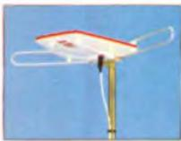
Cette antenne est spécialement conçue pour une utilisation en extérieur. Sa conception la destine aux bateaux, aux caravanes ou au camping. L'alimentation du préamplificateur à faible facteur de bruit (soufflé) peut se faire soit en 110/220 V - 50 Hz, soit en courant continu de 12 V - 65 mA. En regard de ses performances, ses dimensions réduites étonnent compte tenu des efforts qu'elle fournit.
