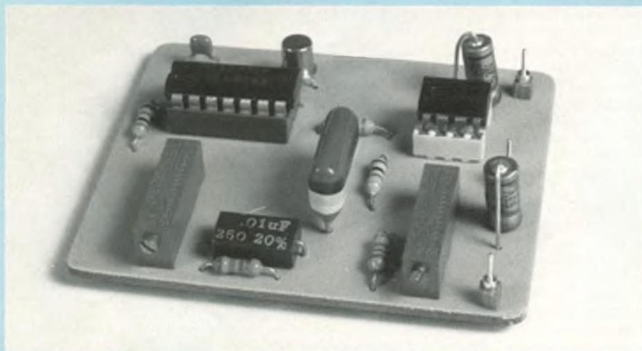
Il est de nombreux montages pour lesquels une tension d'alimentation stable et précise de + 5 V est requise. Citons pour mémoire tous les appareils faisant appel aux circuits intégrés TTL des séries 74 LS xx ou 74 ALS xx dont la tension d'alimentation doit être de + 5 V  $\pm$  5 % ou encore les MOS/74 HC xx ou 74 HCT xx avec + 5 V  $\pm$  10 % sans oublier pour autant les circuits aussi connus et utilisés que les CA 3162 E ou 74 C 925/928 qui demandent aussi une tension de + 5 V.
