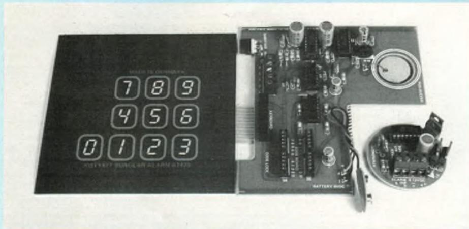
L'alarme au vol AT 475 est construite sur deux cartes de circuits imprimés. La carte A avec ses composants est l'unité centrale comprenant le verrouillage codé. La carte B avec ses composants est l'unité de commande de la sirène. Cette dernière unité est livrée sans boîtier du fait qu'elle doit être montée dans un haut-parleur d'avertisseur L807. La construction et l'installation de l'appareil sont décrites au paragraphe B de la description de montage.
