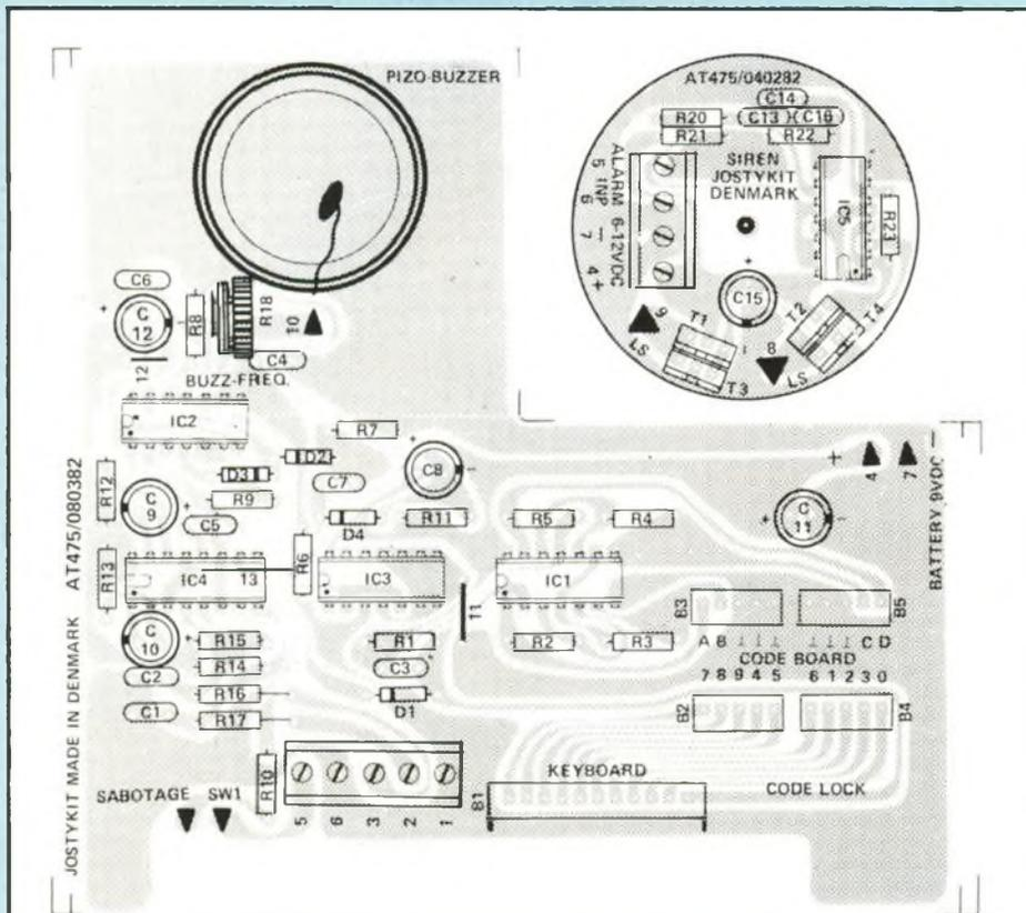
Mise en place des composants sur les deux circuits imprimés.
