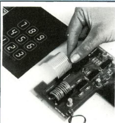
Interconnexions clavier/module par circuit souple et connecteur.
