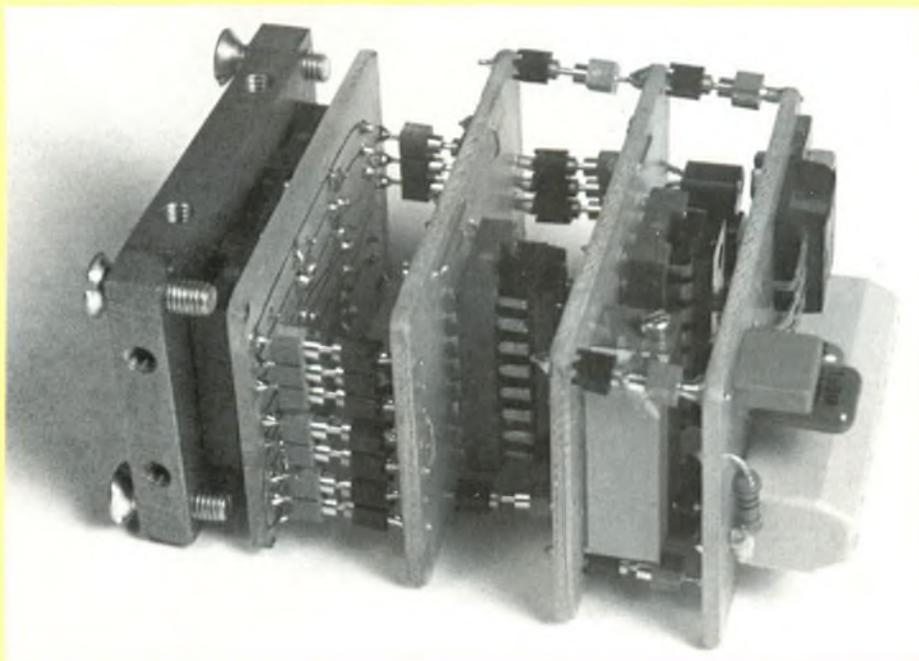
lisation la méthode des bandes et pastilles transfert. Les perçages se font à  $\varnothing$  0,8 mm.
