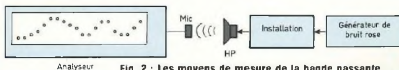
Fig. 2 : Les moyens de mesure de la bande passante.
