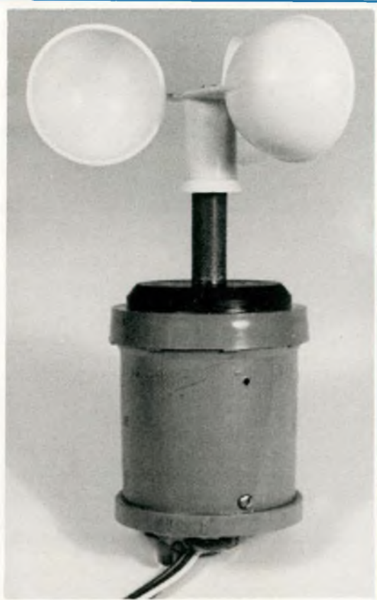
Le moulinet de notre anémomètre terminé.
