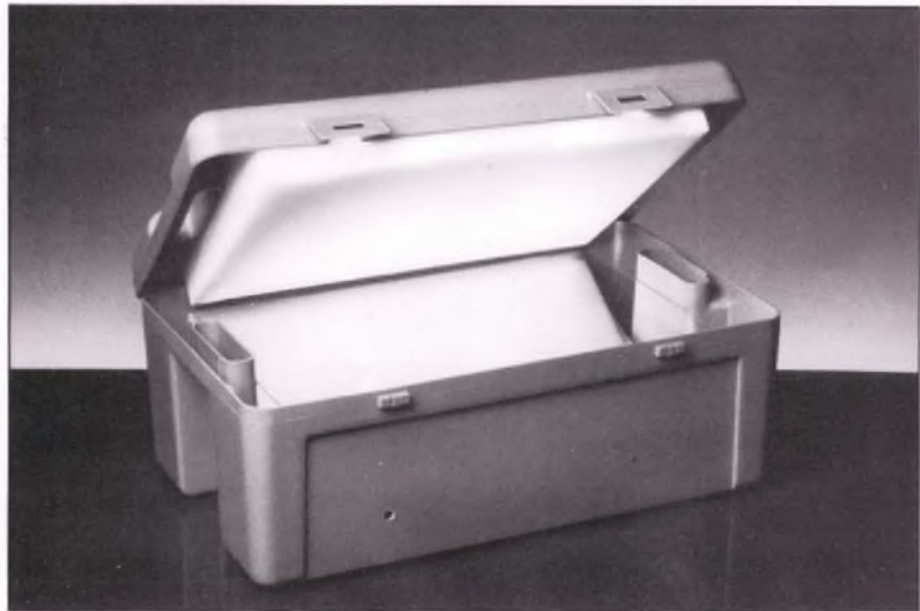
Le dernier-né des bancs à insoler, livré en kit. La gamme 500. Coffret en plastique, avec fermetures, contenant les pièces et fils nécessaires au montage. La minuterie, les starters, les deux tubes actiniques et les douilles se placent et se câblent facilement et rapidement. Surface d'insolation 270 x 400 mm, minuterie temporisée de 0 à 7 minutes. Les tubes s'allument et s'éteignent automatiquement à la fin du temps d'insolation choisi. Simple à monter, simple à utiliser.
