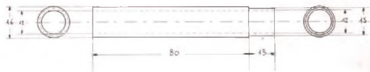
Fig. 3 : Pièce C, tube PVC 12 \times 16 gris ( \times 2) échelle 1/2.
